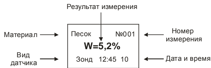
Рис.П.6.2. Вид дисплея при получении результатов измерения влажности
